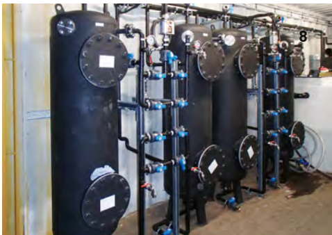
6 UV/O 3 Purificación de aire residual/ 7 Prueba de laboratorio ISCO/ 5,8,9 Instalaciones de prueba para material adsorbente, IAT/ 10 Prueba de campo ISCO, Alemania
